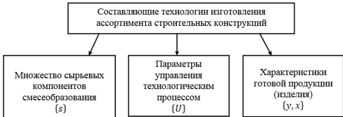
Рисунок 6 – Группы параметров управления изготовлением изделий из бетона
