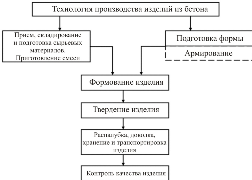
Рисунок 4 – Схема перделов процесса производства изделий из бетона
