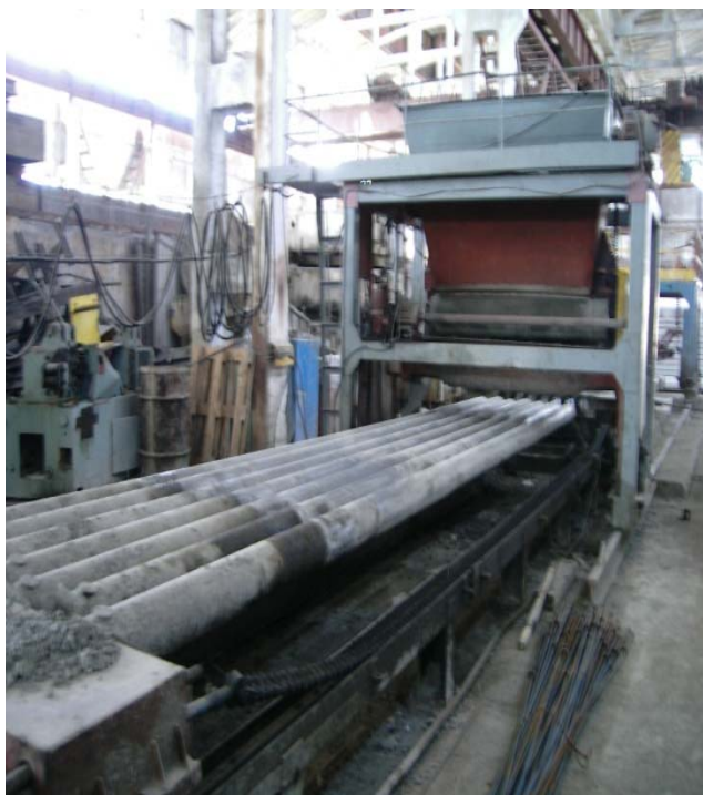
Рисунок 49 – Установка для изготовления плит перекрытия многопустотных (а); экспериментальный образец плиты ПК 60-12-8 (б)
