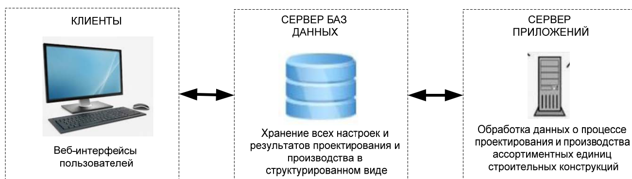
Рисунок 32 – Архитектура информационной системы выбора характеристик строительных материалов конструкций объектов недвижимости
