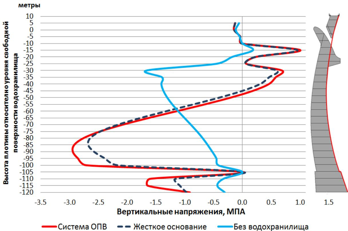
Рис. 4.4.19. Вертикальные напряжения на нижней грани центрального сечения арочной плотины от гидростатической нагрузки, с учетом собственного веса (в МПа).
