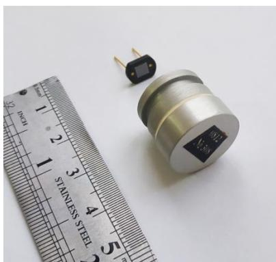
Рисунок 3 – Компоненты датчика рентгеновского излучения:
