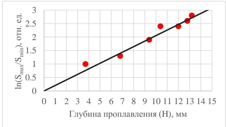
Рисунок 9 – Экспериментальная зависимость параметров проходящего рентгеновского излучения от глубины проплавления при ЭЛС стали 15Х5М с продольной осцилляцией луча ( $P=3$  кВт, частота осцилляции  $f=645$  Гц, размер развёртки  $2A=1,5$  мм)
