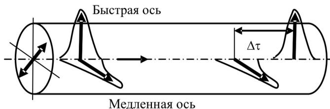
Рис. 11.8. Уширение импульсов в поляризованном волокне
