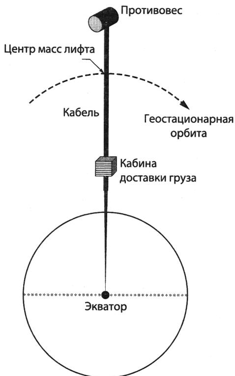
Рис. 9.8. Космический лифт для доставки грузов на геостационарную орбиту
