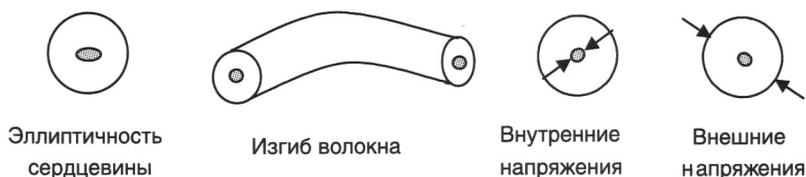
Рис. 11.7. Причины возникновения поляризации (двулучепреломления) в оптических волокнах
