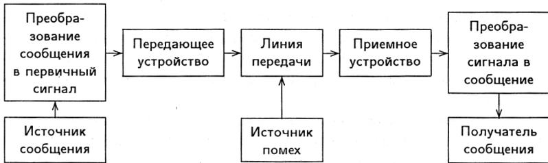
Рис. 12.8. Функциональная схема передачи информации
