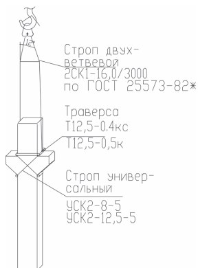
Рис. 8.9. Схема строповки колонны КС-1 при монтаже
