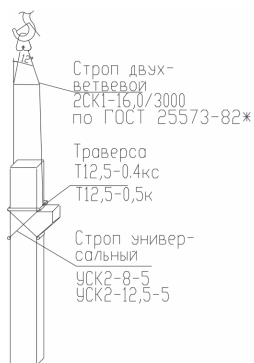
Рис. 8.7. Схема строповки колонны КК-2 при монтаже
