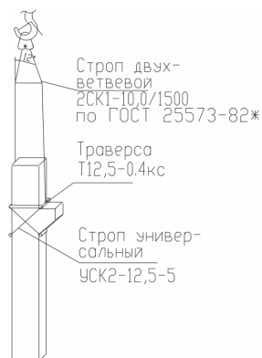
Рис. 8.5. Схема строповки колонны КК-1 при монтаже
