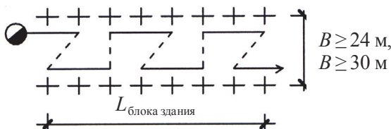
Рис. 8.27. Проходка крана при монтаже колонн по зигзагу в пролете.
