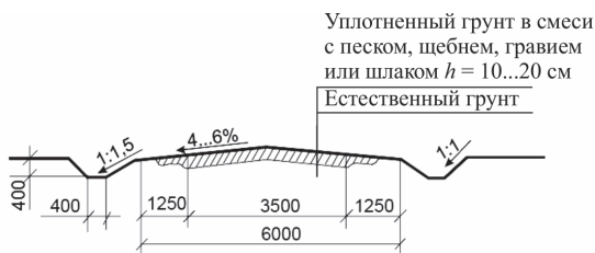
Рис. 2.6. Пример проектирования грунтовой внутрипостроечной дороги
