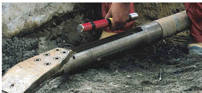
Рис. 2. Буровая головка с излучателем
