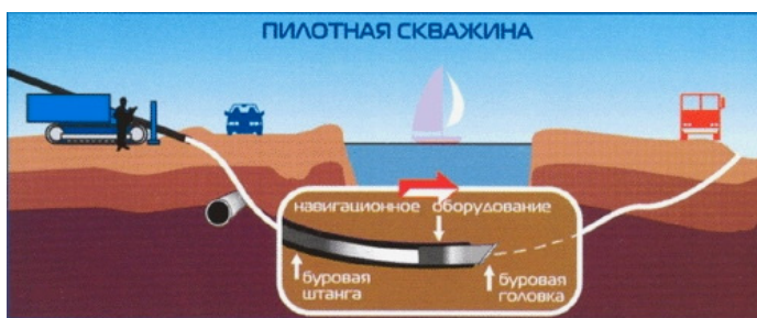
Рис. 1. Бурение пилотной скважины
