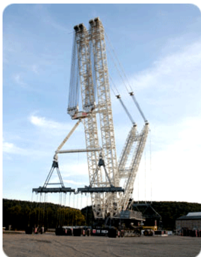
Рис. 1. Самый большой в мире гусеничный кран SS 8800-1 Twin грузоподъемностью 3200 т (фирма Terex Demag GmbH)
