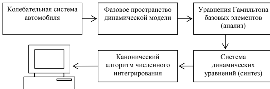
Рис. 2. Схема построения компьютерной модели колебаний элементов автомобиля
