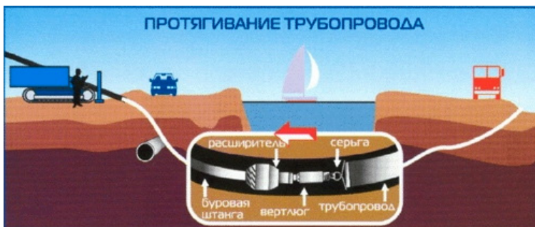
Рис. 4. Процесс укладки трубопровода
