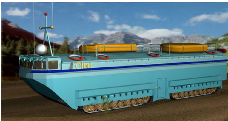
Рис. 5. Экономичная авиатранспортабельная гусеничная эвакуационная амфибия AS40 «Рука помощи» (Helping hand)
