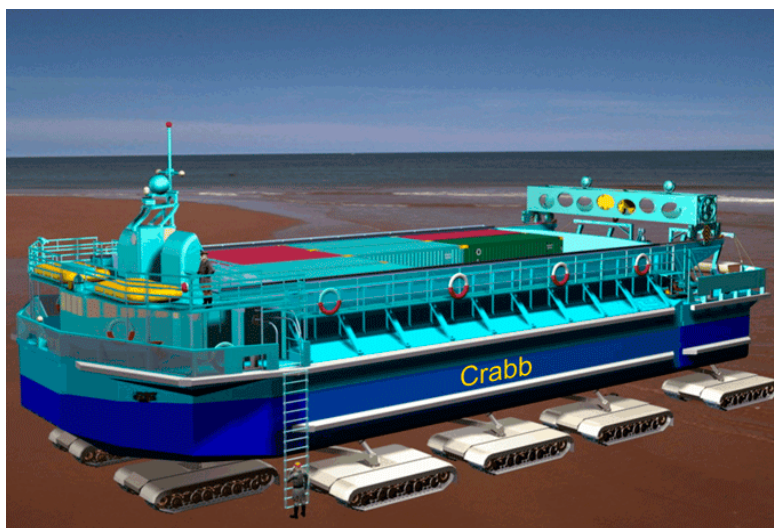
Рис. 4. Контейнерная модификация экономичной амфибии А480 Crabb грузоподъемностью 480 т на мягком влажном грунте при загрузке пассажира с грунта по штатной лестнице
