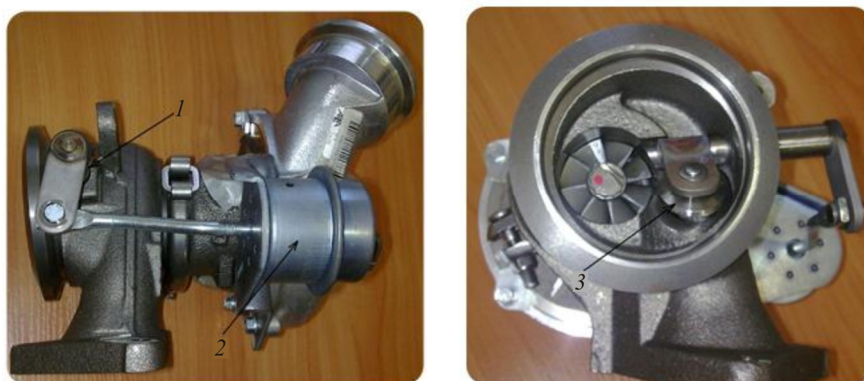
Рис. 2. Турбокомпрессор с перепускным устройством: 1 – рычаги управления заслонкой; 2 – пневматическая камера управления; 3 – заслонка
