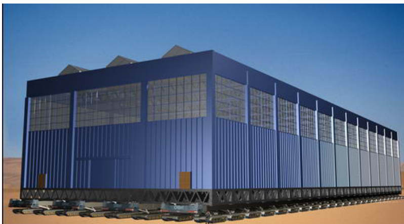
Рис. 7. Экономичный высокоманевренный гусеничный транспортер Cr16000 при движении по пустынной территории с корпусом электростанции массой 16 тыс. т
