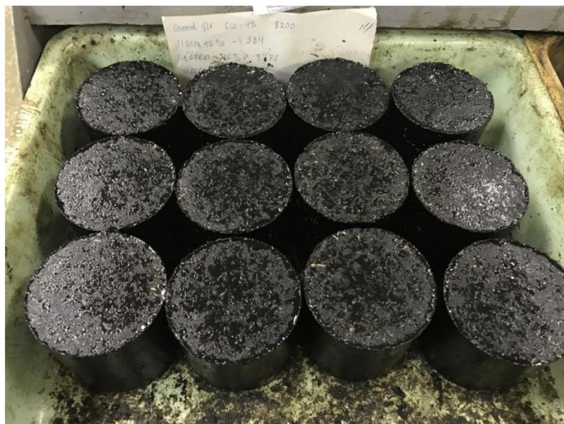
Рисунок 2.2 – Сформованные асфальтобетонные образцы
