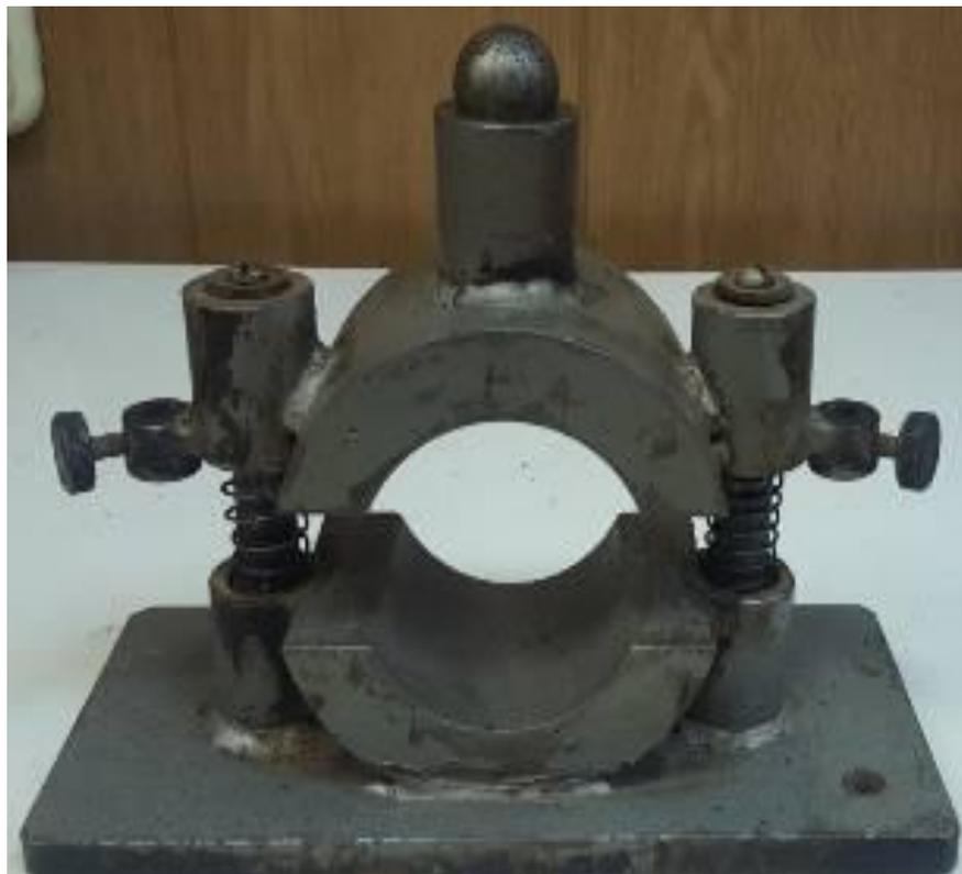
Рисунок 2.6 –Установка для определения сдвиговых характеристик по схеме Маршала.
