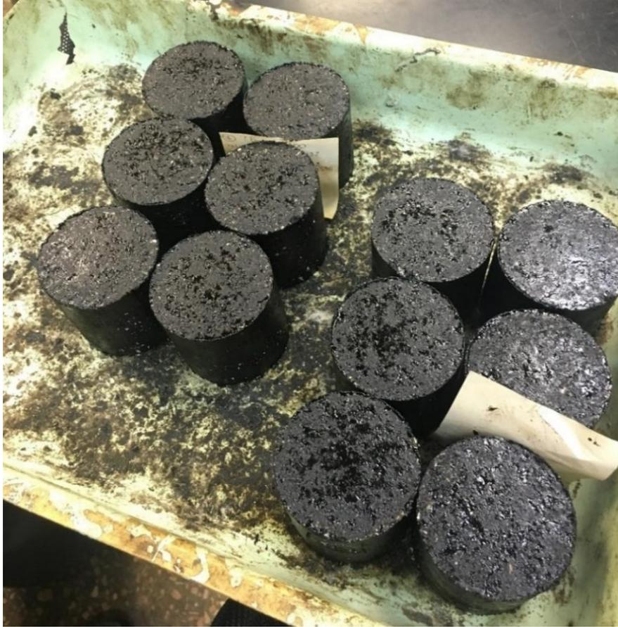
Рисунок 4.1 – Полученные образцы асфальтобетона
