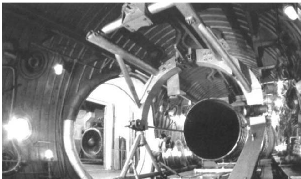
Рисунок 1.5 – Общий вид термобарокамеры НИЦ ЦИАМ им. П.И. Баранова.
