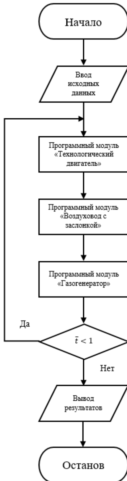
Рисунок А.1 – Обобщенная блок-схема программной реализации математической модели процесса подогрева и наддува воздуха на входе газогенератора турбореактивного двухконтурного двигателя.
