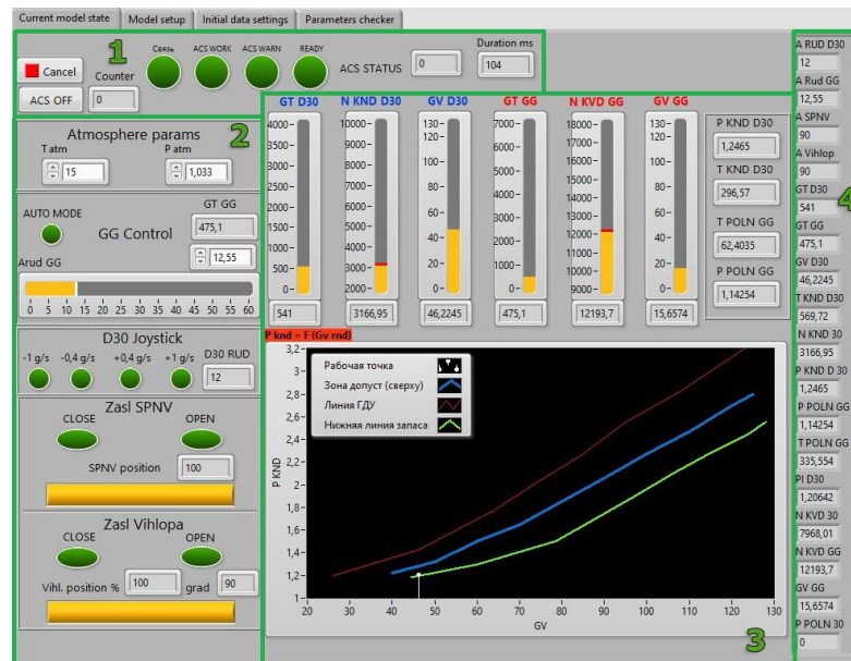
Рисунок 3.7 Общий вид пользовательского интерфейса модуля отладки установки полунатурного моделирования.
