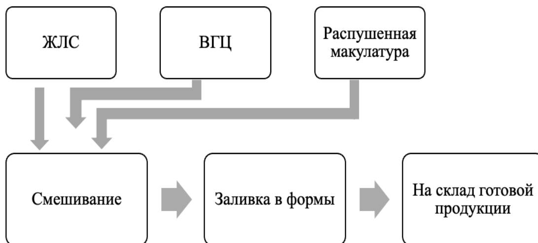
Рисунок 4.21 – Предполагаемая схема утилизации ЖЛС с получением лигноцементных блоков
