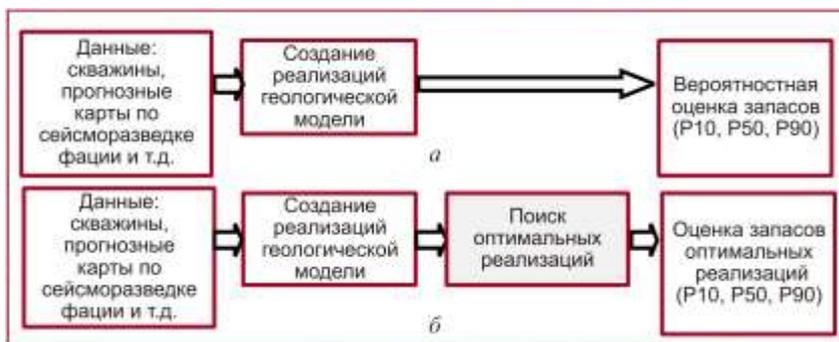
Рисунок 2 – Сопоставление схем технологии 3D-многовариантного геологического моделирования: *a* – стандартный подход; *б* – моделирование с контролем качества реализаций
