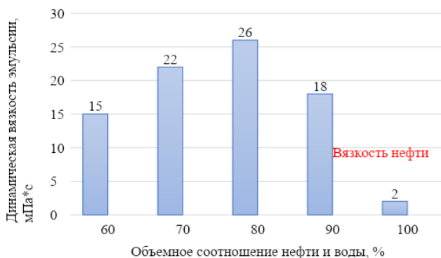
Рисунок 4 – Зависимость динамической вязкости эмульсии от объемного соотношения нефти и воды
