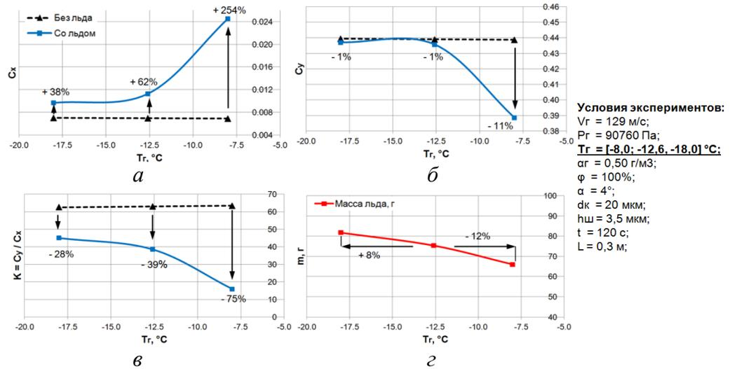
Рисунок 3 – Влияние температуры газодинамического потока на коэффициент аэродинамического сопротивления (а), коэффициент подъемной силы (б), аэродинамическое качество (в) и массу льда (г)
