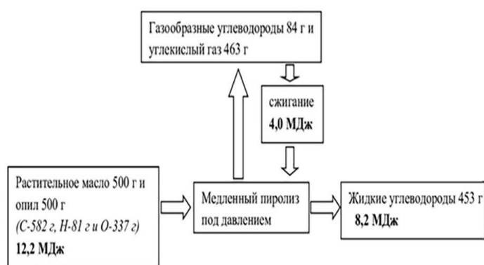
Рисунок 3. Энергетический и материальный балансы процесса медленного пиролиза
