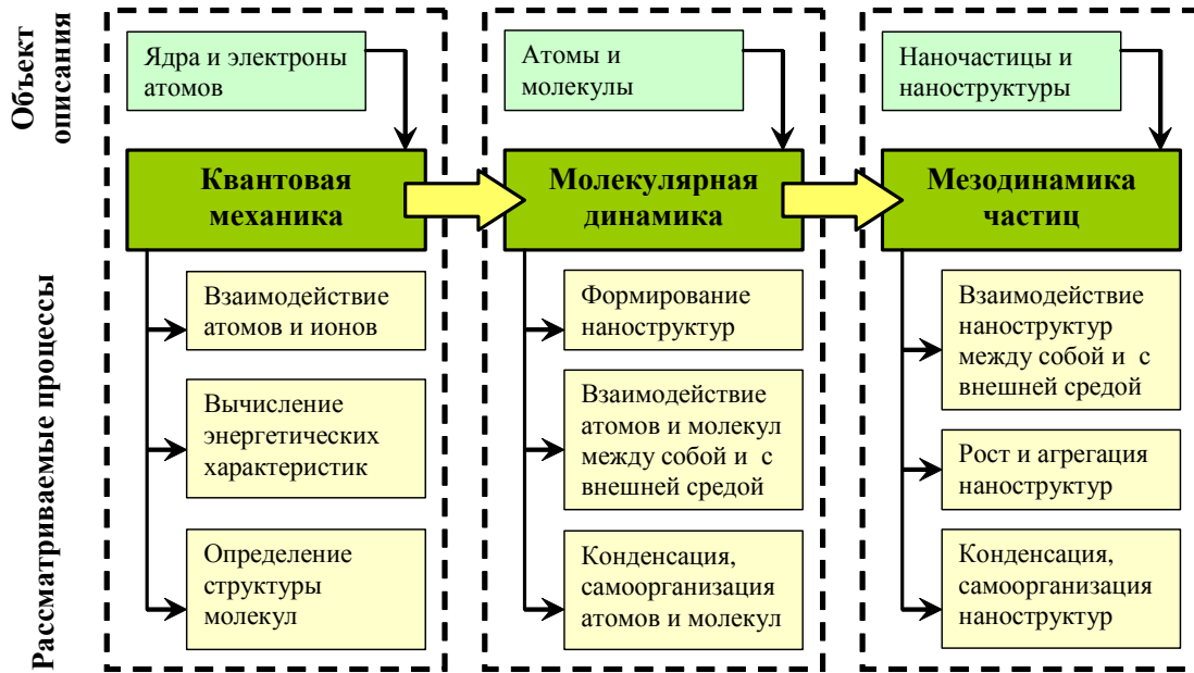
Рисунок 1 – Структура комплексной модели для исследования функционирования технических систем и технологических процессов с газогенератором наноструктур
