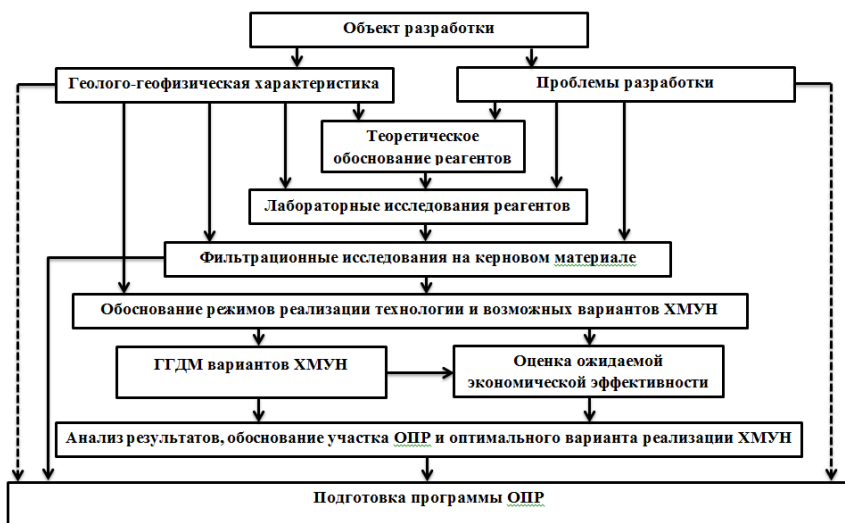
Рисунок 7 – Схема комплексного подхода для подбора технологий химического воздействия на пласт
