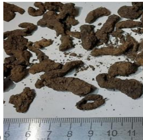
Рисунок 3 – Частицы ПНД в структуре асфальтобетона: а) схема перераспределения действия сил в структуре асфальтобетона, 1 – ПНД, 2 – распределение сил в структуре асфальтобетона при действии вертикальной внешней нагрузки, 3, 4 – распределения нагрузки через ПНД, 5 - нагрузка от воздействия колес автотранспорта; б) частицы ПНД после экстрагирования.
