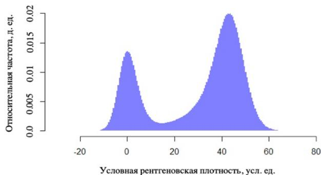
*Слева – двухмерный срез реконструированного объемного изображения керна, справа – гистограмма распределения оттенков серого в объемном изображении керна*
