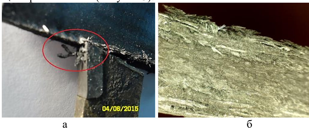
Рисунок 3 – Схема стружкообразования при ортогональной лезвийной обработке ПКМ: а – упругое деформирование армирующих волокон; б – обработанная поверхность углепластика
