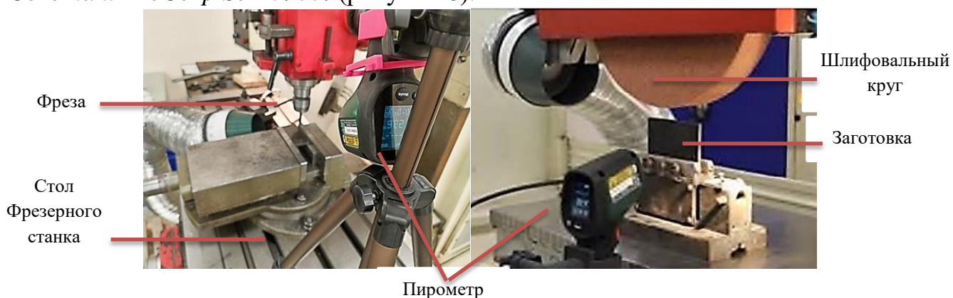
Рисунок 8 – Механическая обработка лезвийным и абразивным инструментом
