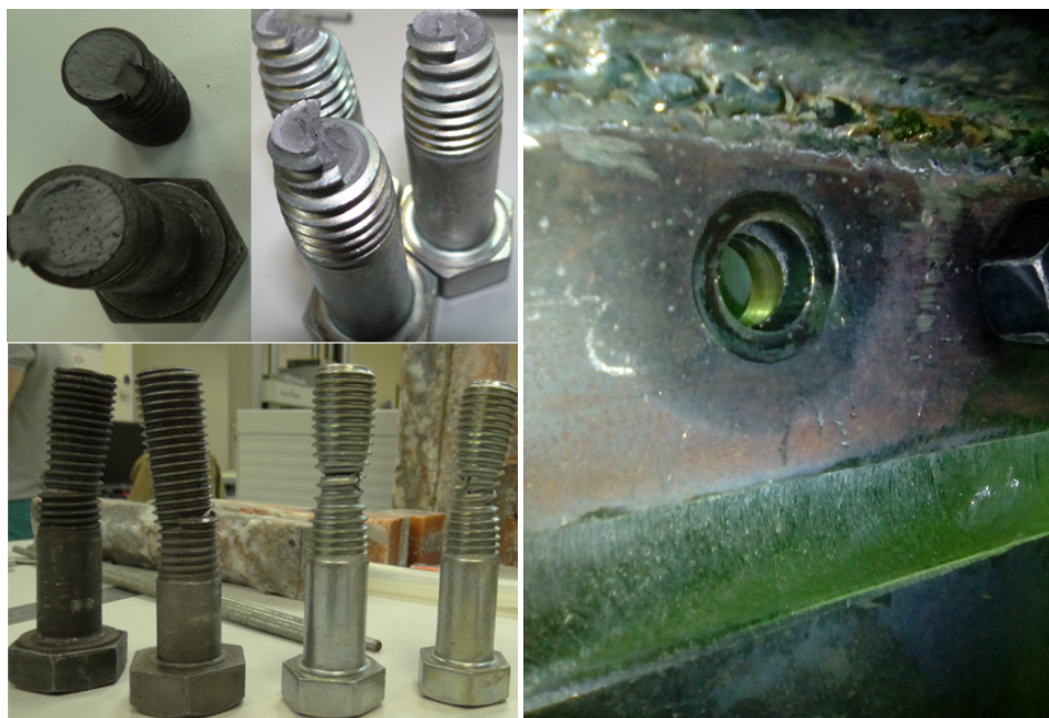
Рисунок 5 – Общий вид болтов после испытаний и зона местного смятия
