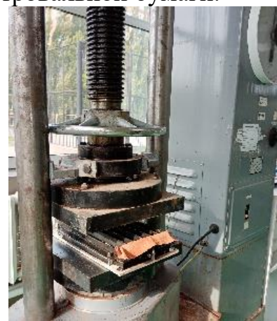
в) – начальный этап процесса фильтрационного прессования
