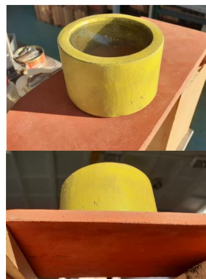
Рисунок 14 – Испытание на водонепроницаемость
