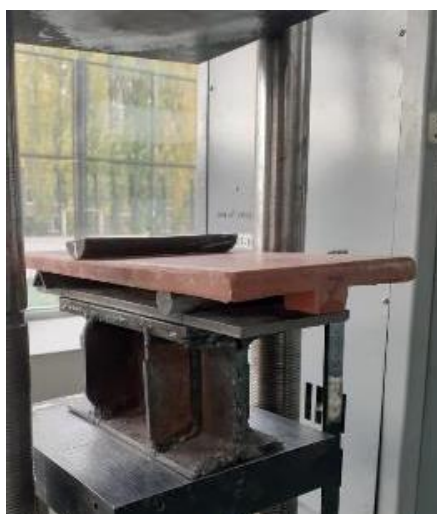
Рисунок 13 – Испытание цементно-песчаной черепицы на изгиб
