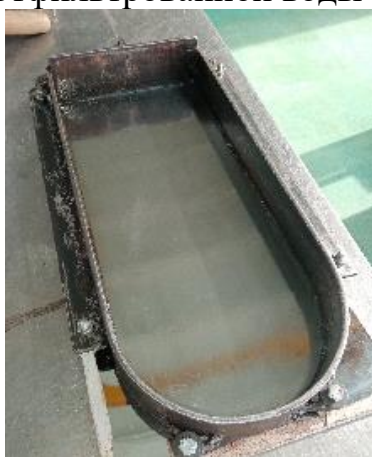
а) – нижняя часть пресс-формы (матрица)
