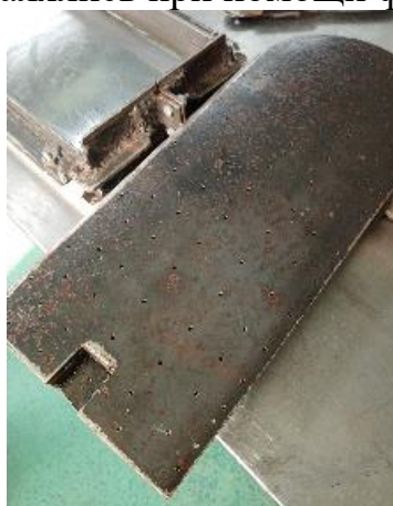
б) – верхняя часть пресс-формы (пуансон) (вид снизу)
