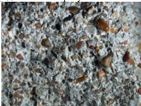
Рисунок 9 – Фотографии цементно-песчаного композита, полученные на оптическом микроскопе при увеличении в 20 раз
