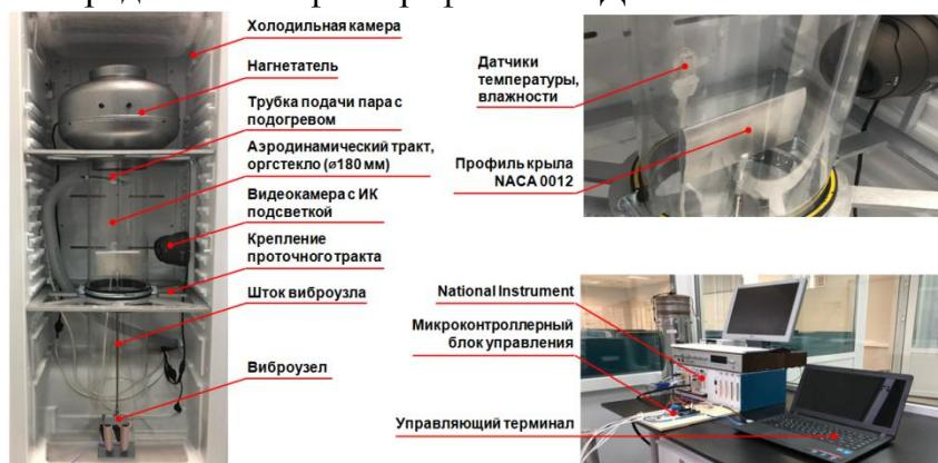
Рисунок 7 – Модельная климатическая аэродинамическая труба: общий вид (а), аэродинамический профиль и система управления (б)
