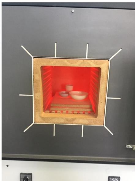
Рисунок 3.1 – Высокотемпературная печь марки SNOL 12/1300 с образцами исследуемых глин на отжиг 800 °С
