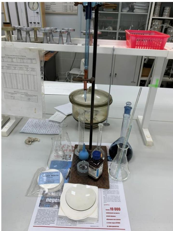
Рисунок 3.3 – Рабочие материалы для проведения испытаний на адсорбционные свойства исследуемых глин
