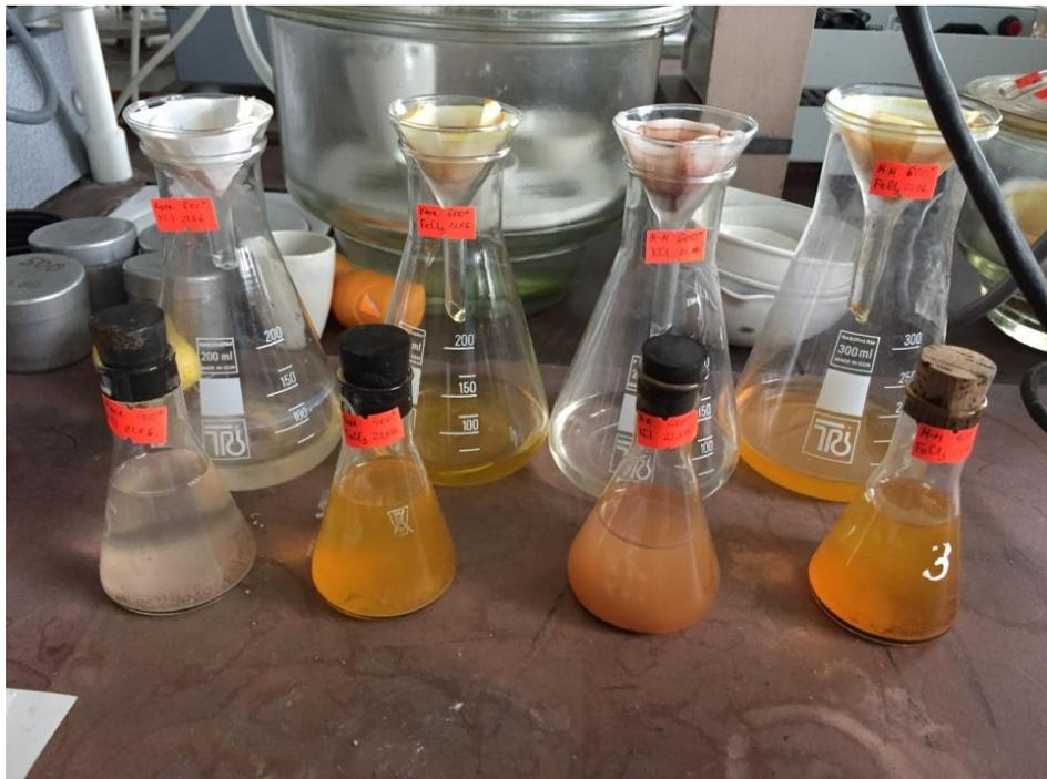
Рисунок 4.1 – Насыщение образцов глин катионными растворами и их фильтрация в лабораторных условиях
