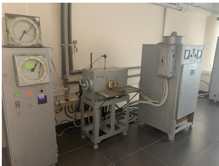
Рисунок. 20. Внешний вид установки для ТМО
