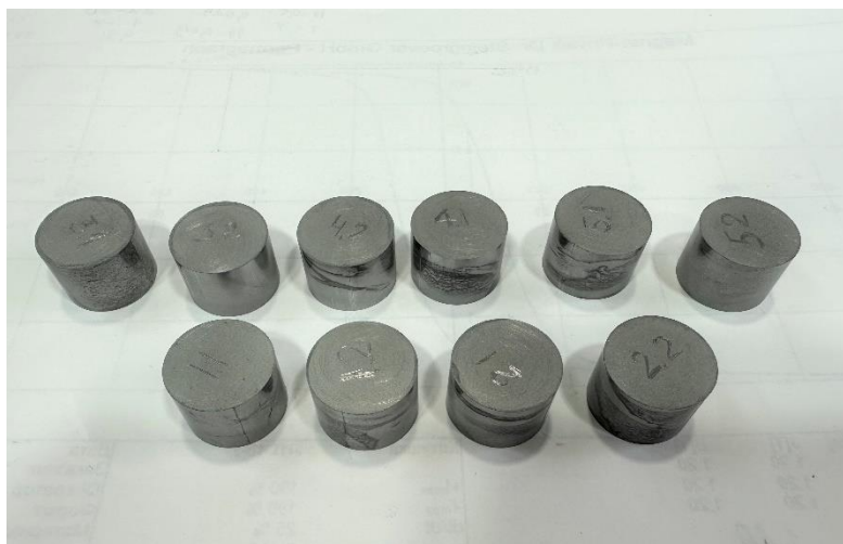
Рисунок 19. Образцы исследуемых сплавов после окончательного прессования
