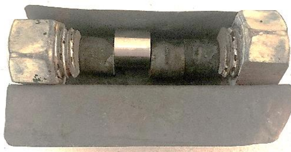
Рисунок 21. Способ укладки образцов для ТМО
