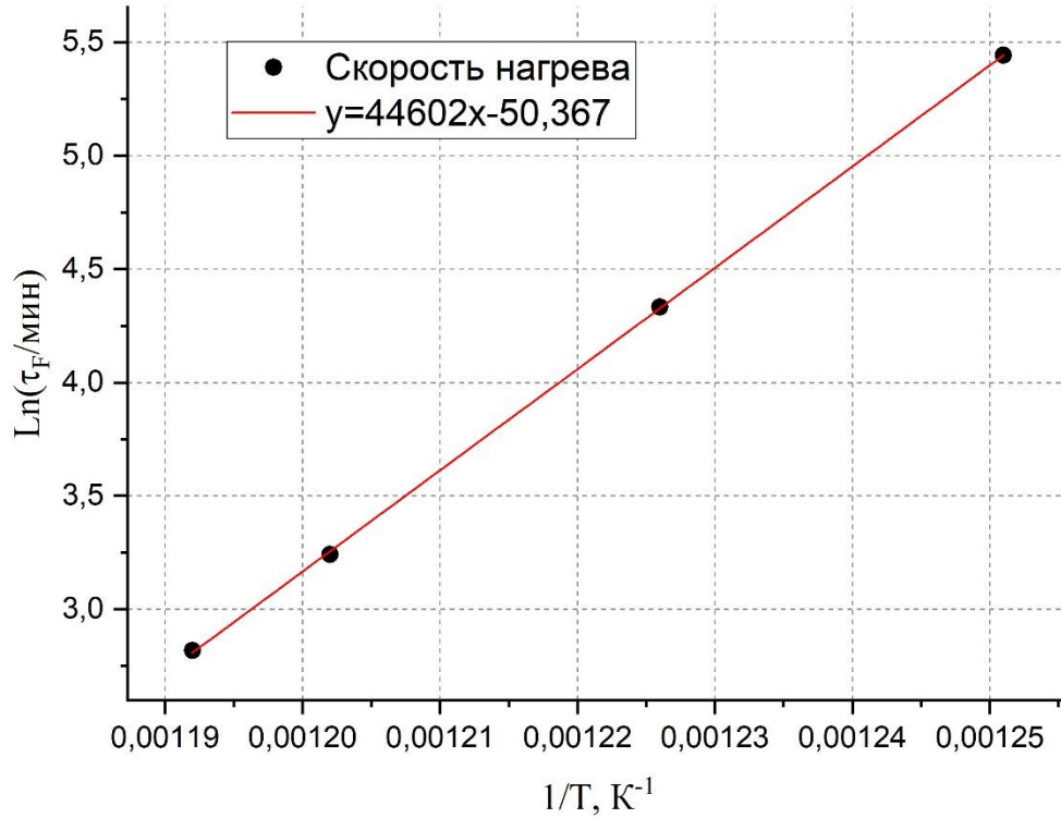
Рисунок 3.19. График Аррениуса для ОВ в водороде для F = 25 \%
