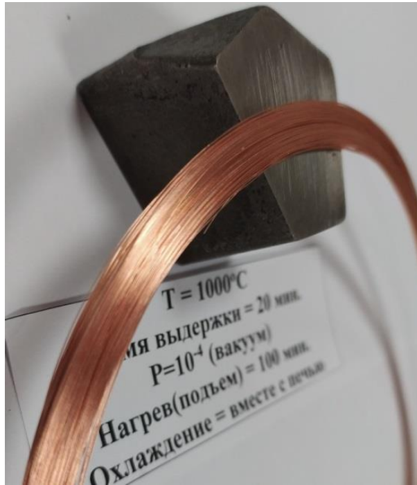
Рисунок 5.5. Внешний вид свободной намотки оптического волокна с медным покрытием после термообработки на 1000 °С
