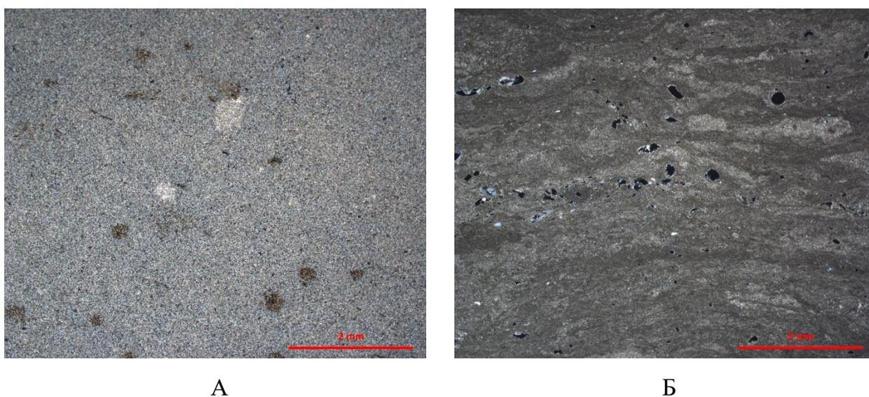
*Рис..4.2. Микроскопическая структура доломитовых пород в скрещенных николях:*
