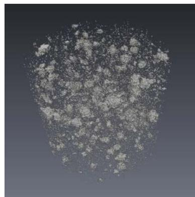
3D-модель распределения уплотнений в образце 30 мм
