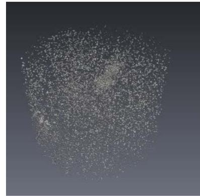
3D-модель распределения уплотнений в образце 30 мм
