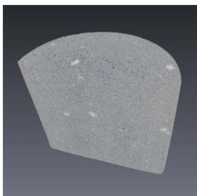
3D-модель распределения пустот в образце 5 мм
