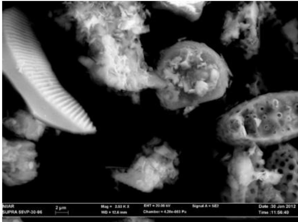
Рисунок 116 – РЭМ-изображение образца Инзенского диатомита после измельчения на сушильно-дробильном агрегате Atritor при температуре теплоносителя на входе 350 °С (2530-кратное увеличение)
