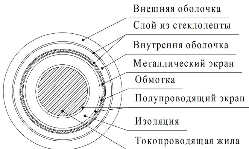
Рисунок 3.2 – Конструкция силового кабеля АПВВнг-LS
