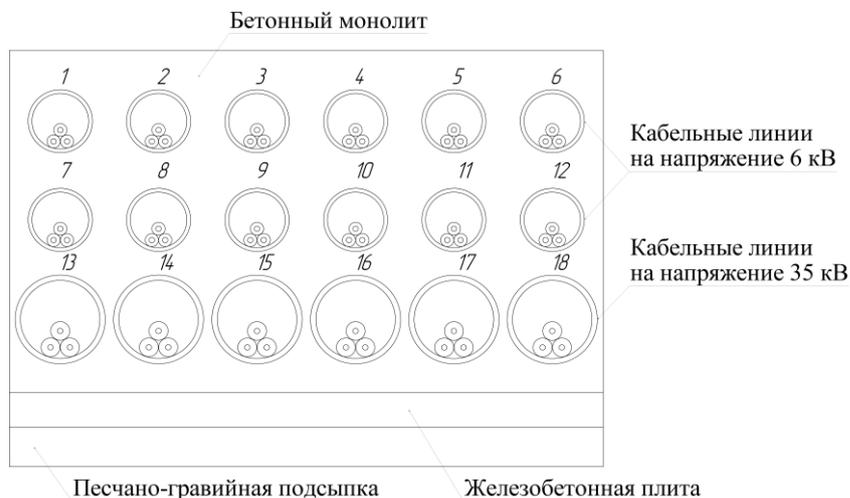
Рисунок 3.1 – Схема кабельного блока
