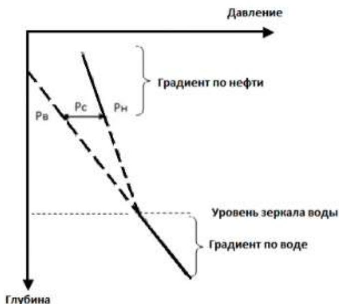
Рис. 3.5. График зависимости давления от глубины [128].
