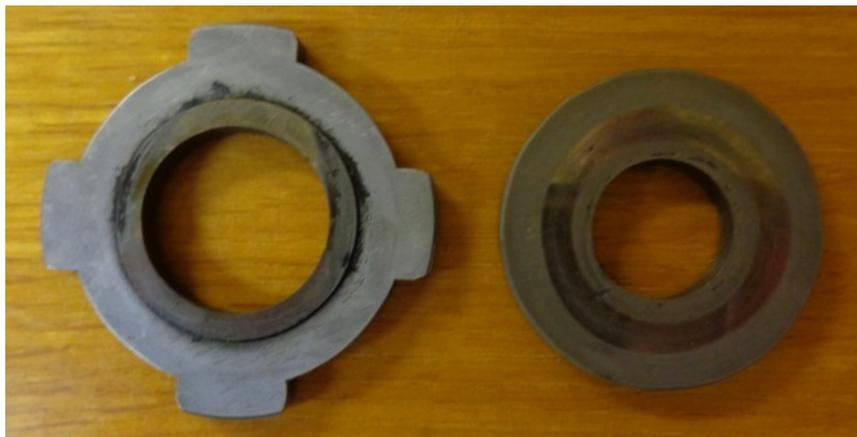
Рисунок 141 – Внешний вид пары трения «Кольцо неподвижное» - «Кольцо» после испытаний
