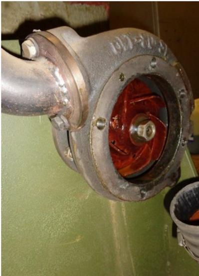
Рисунок 137– Внешний вид корпуса насоса без крышки
