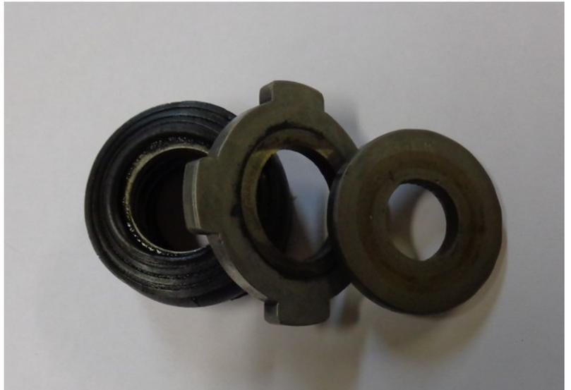
Рисунок 138 – Внешний вид деталей торцевого уплотнения насоса
