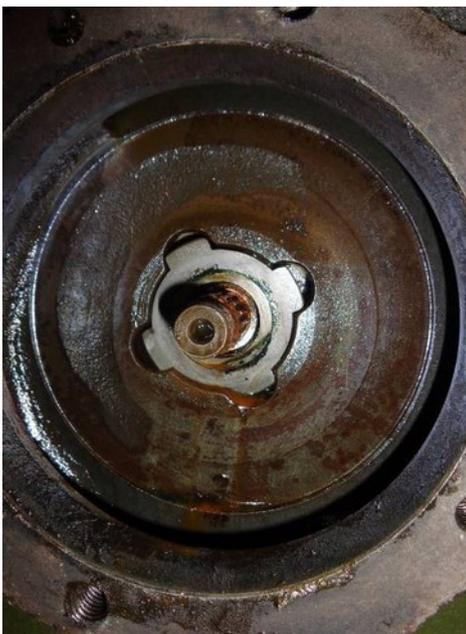
Рисунок 139 – Монтаж «Кольца неподвижного»
