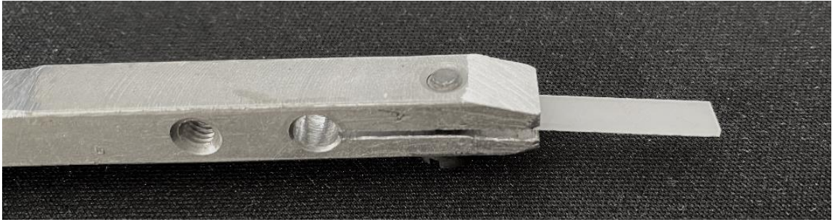
Рисунок 41 – Инструмент для удаления оксидной пленки под слоем расплава припоя, представляющий собой тонкую пластинку поликристаллического корунда
