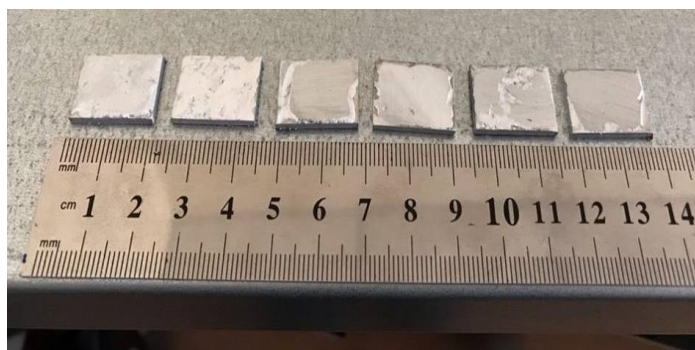
Рисунок 10 – Образцы, луженные припоем HTS-2000, для изучения влияния режимов нагрева на микроструктуру зоны взаимодействия
