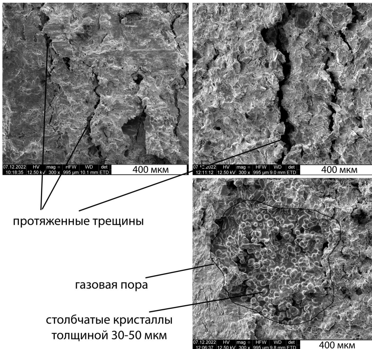
Рисунок 35 – СЭМ изображения изломов образца №1, где регистрируются протяженные трещины длиной от 100 до 400 мкм. Показана газовая пора с сохранением микроструктуры столбчатых кристаллитов
