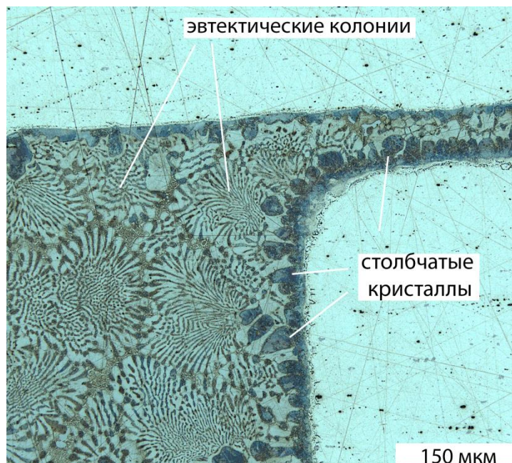
Рисунок 27 – Поперечный шлиф зоны галтели, показывающий переход от зоны столбчатых кристаллов на границе с основным материалом к развитым эвтектическим колониям с характерным размером 100-150 мкм
