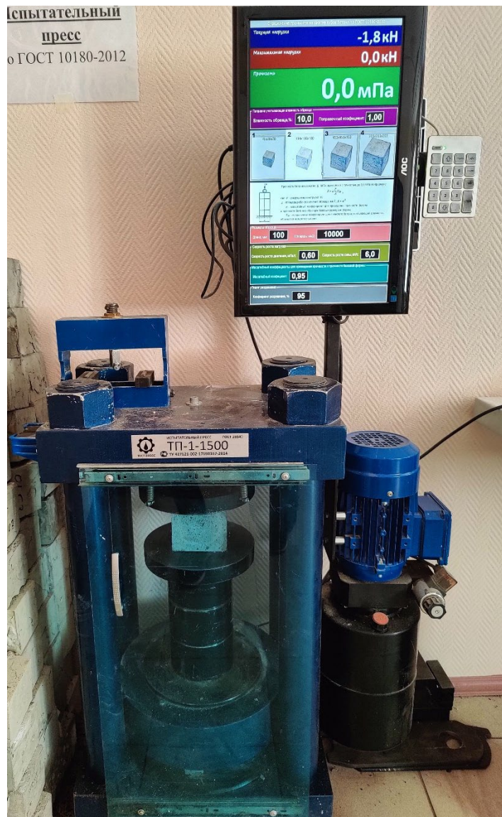
Рисунок 3.1 – Испытания образцов бетона сжатие на испытательном прессе ТП-Т1500
