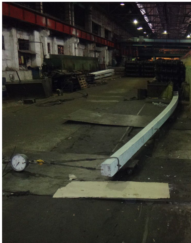
Рисунок 5.2 – Испытания стойки СВ95-3с на заводе ООО «Рыбинскэнергожелезобетон»
