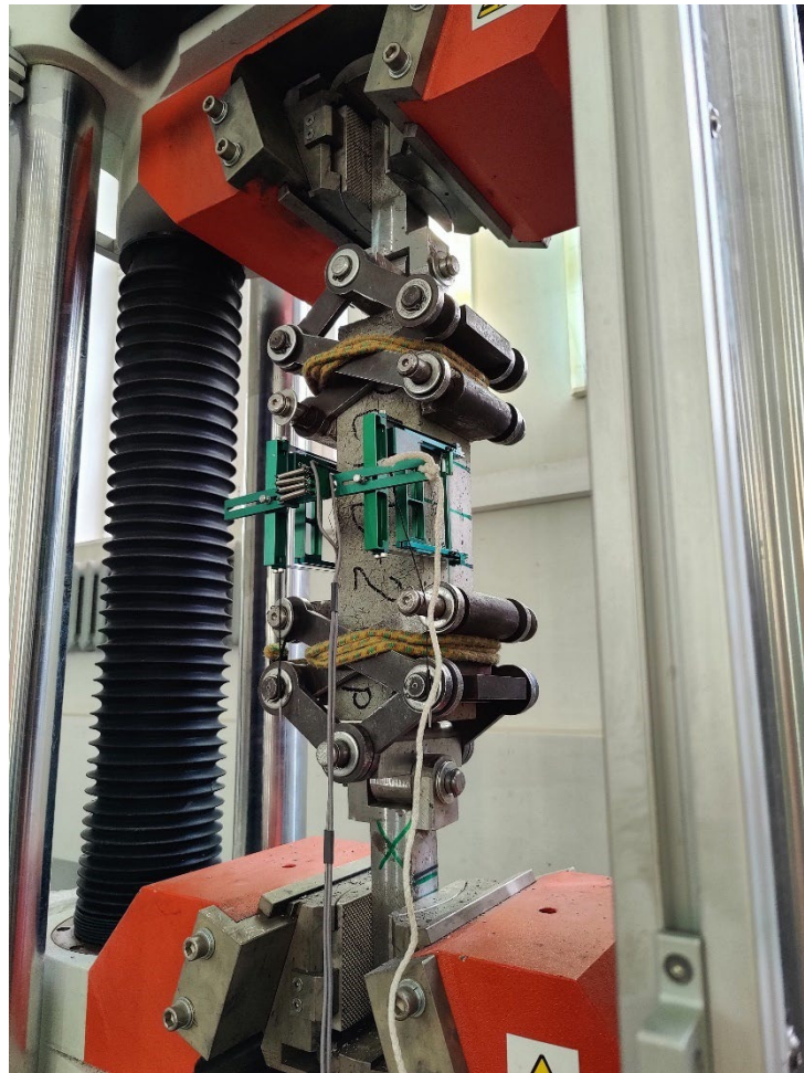
Рисунок 3.2 – Испытания образцов бетона на испытательной машине Powertest U-600
