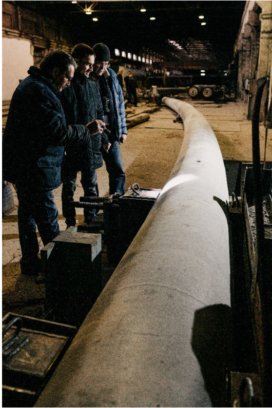
Рисунок 5.1 – Испытания стойки СК26.1-1.1 на заводе ООО «Рыбинскэнергожелезобетон»
