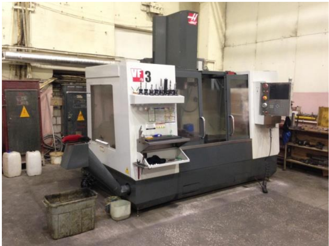
Рисунок 3.5 – Вертикально-фрезерный обрабатывающий центр Haas VF-3
