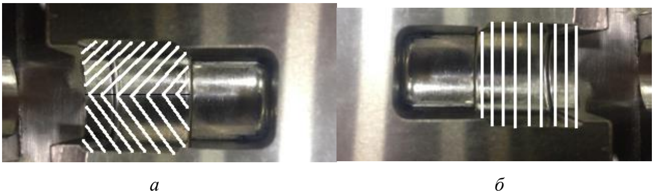
Рисунок 4.25 – Траектория обработки восьми гнезд матрицы детали «Заглушка» с \alpha=45^\circ (а) и траектория обработки восьми гнезд матрицы детали «Заглушка» с \alpha=90^\circ (б)
