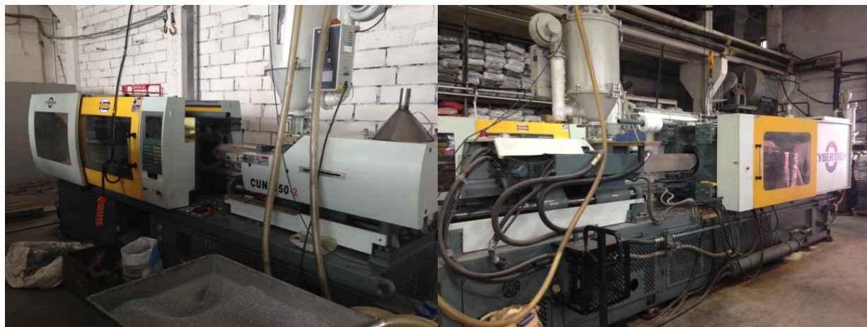
Рисунок 3.11 – Термопластавтоматы CUN для литья деталей из ПКМ под давлением
