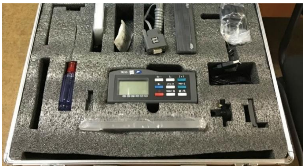
Рисунок 3.9 – Комплект профилометра TR210 для измерения шероховатости
