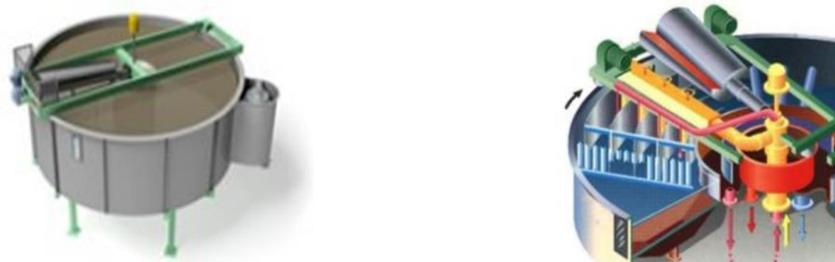
Рисунок 5.2 – Флотационный фильтр
