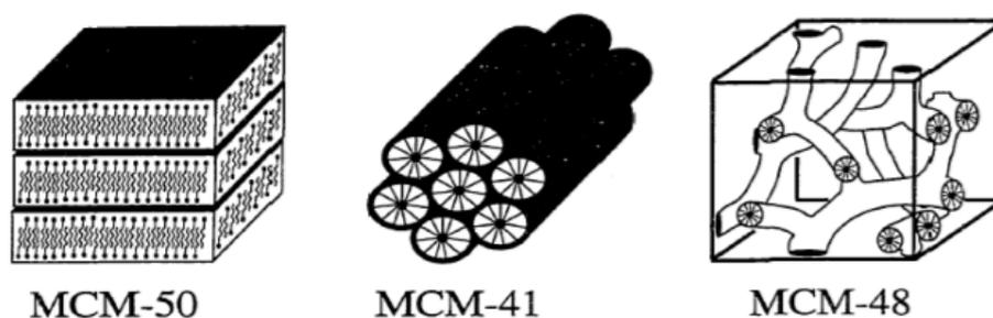
Рисунок 1.20 – схематическое изображение материалов семейства M41S
