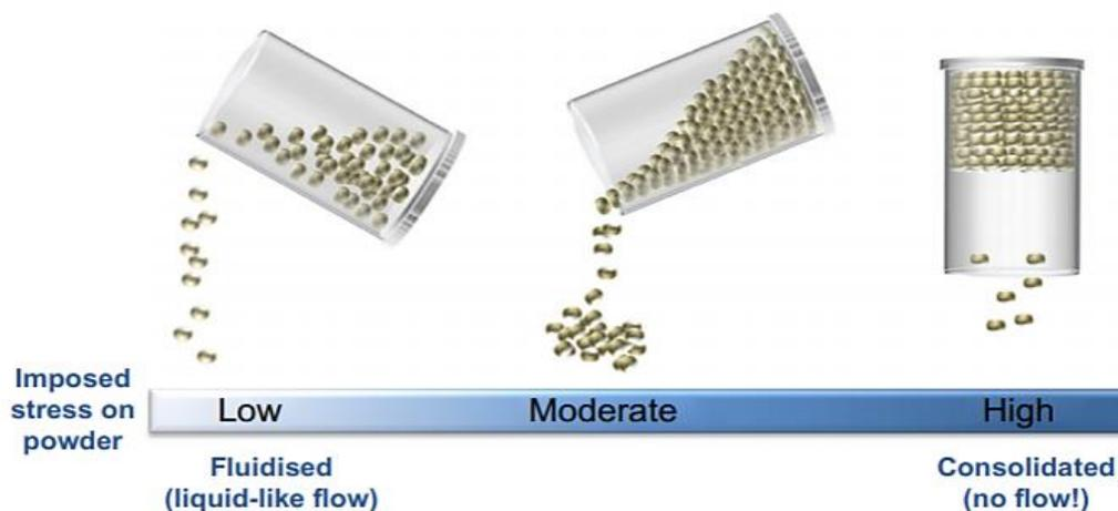
Рисунок 1.22 - Схематическое отображение текучести порошка
