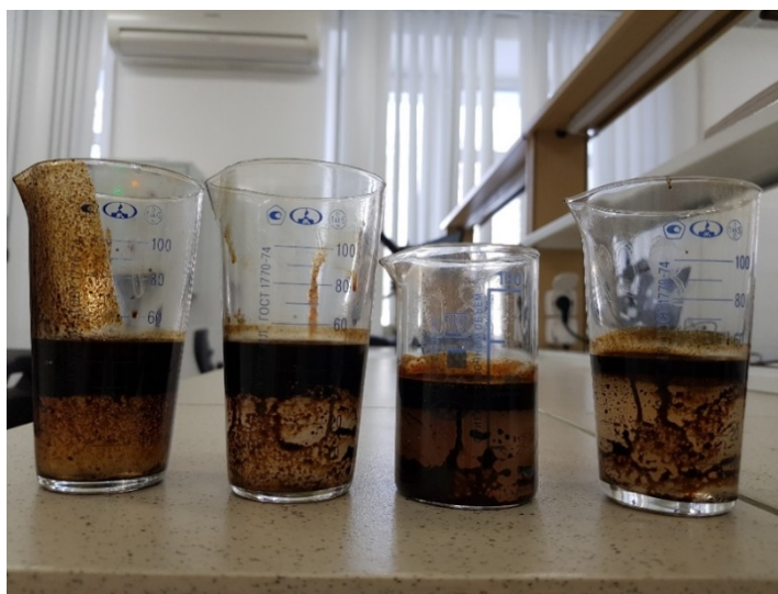
Рисунок 4.10 – Пробы водонефтяной эмульсии с разной обводненностью после перемешивания 2800 об./мин в течение 2 мин при 10 °С (слева направо: обводненность 59; 70; 80; 90 %)
