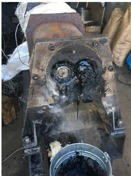
Рисунок 6.2. Двухшнековый экструдер с обогревом шнеков в процессе работы
