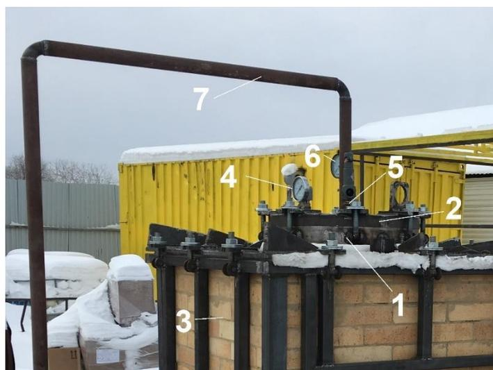
Рисунок 6.1 - Реактор для пиролиза под давлением растительного масла: 1 - реторта реактора, 2 - крышка реактора, 3 - корпус печи, 4 – термопара, 5 – клапан регулировки давления, 6 – манометр, 7 – трубопровод выхода продуктов пиролиза
