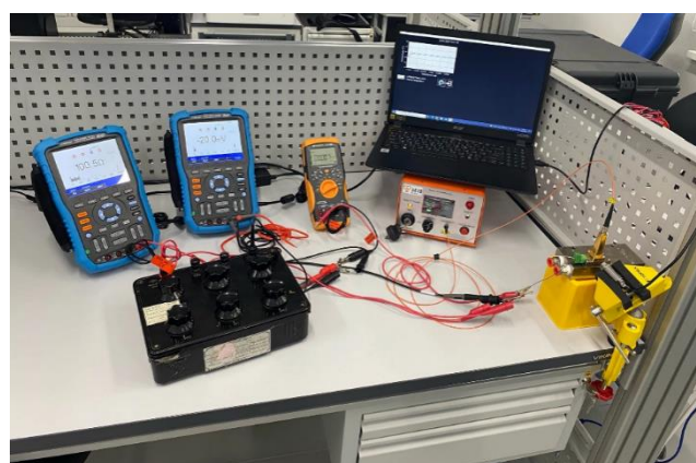
Рисунок 2.12. а) Блок-схема исследования нагрузочной характеристики фотоэлектрического преобразователя; б) Фотография собранного рабочего места
