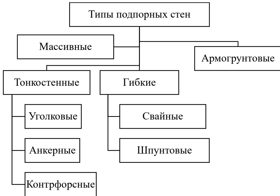
Рисунок 1.1. Классификация подпорных стен
