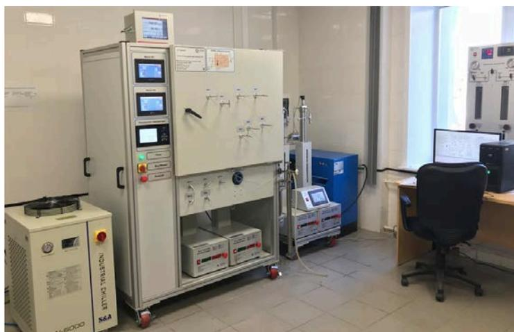
Рисунок 2.2 – Установка ПИК-PVT для тяжелых нефтей
