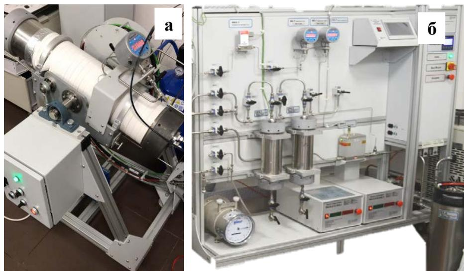
Рисунок 2.1 – Установка ПИК-ППФ: а) ячейка для рекомбинирования проб нефти, б) стойка с блоками заполнения ячейки рекомбинирования
