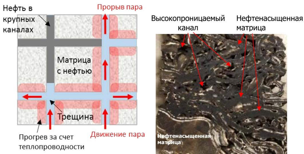
Рисунок 1.1 – Схематичное изображение процесса вытеснения нефти паром из трещинного пласта и фотография реального кернового материала пермокарбоновой залежи Усинского месторождения
