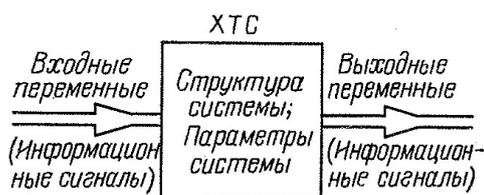
Рис. 1.5 - Схема ХТС как объекта исследования
