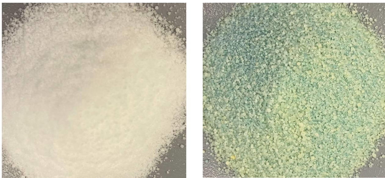
Рисунок 5.13 – Внешний вид хлорида калия: а – необработанный антислеживателем КСl, производимый в РВКУ БКПРУ-4 ПАО «Уралкалий»; б – продукт КСl, изменивший цвет и возвращенный предприятию потребителем
