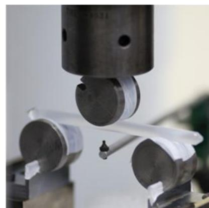
Рисунок 3.3 – Испытание заготовки силового стержня
