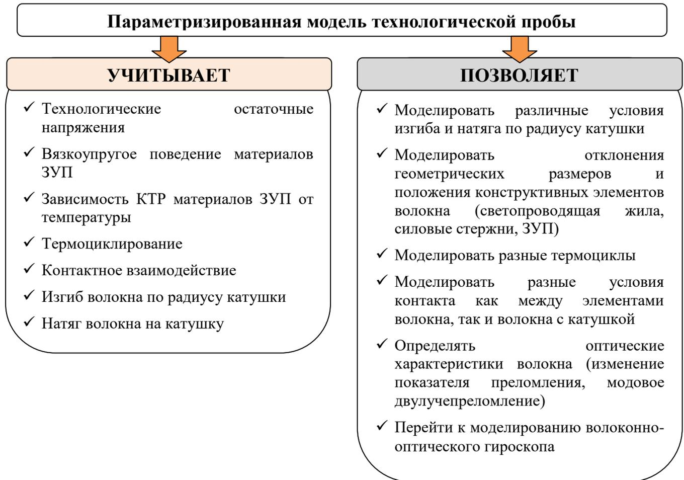
Рисунок 4.2 – Возможности математической модели технологической пробы
