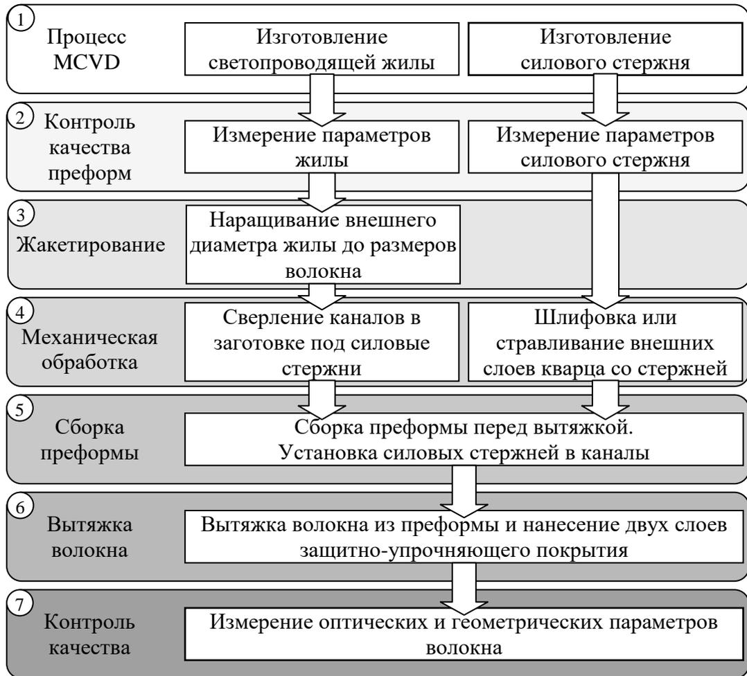
Рисунок 1.1 – Этапы изготовления анизотропного оптического волокна типа Panda
