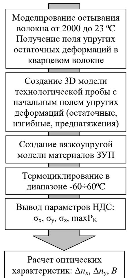
Рисунок 4.1 – Алгоритм численного моделирования
