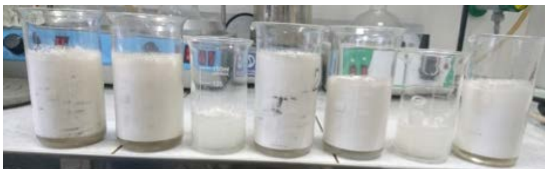
Рис. 3.9. Реакция «таблеток» горной породы с кислотным составом НПС-К по истечении пяти минут
