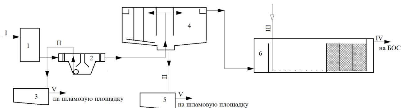
Рисунок 5.13 – Схема механической очистки производственных СВ ПАО «Нижекамскнефтехим»: 1 – смеситель ; 2 – песколовки химстока; 3, 5 – шламонакопители, 4 – первичные радиальные отстойники; 6 – усреднители: I – сточная вода; II – шлам; III – воздух; IV – условно очищенная вода; V – обезвоженный шлам
