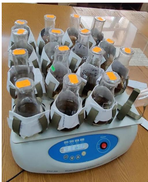
Рисунок 2.6 – Модификация образцов ЦСО растворами кислот
