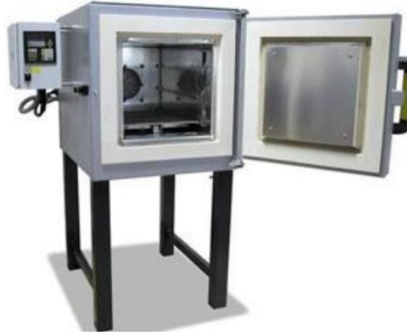
Рисунок 2.11 – Сушильный шкаф с принудительной конвекцией
