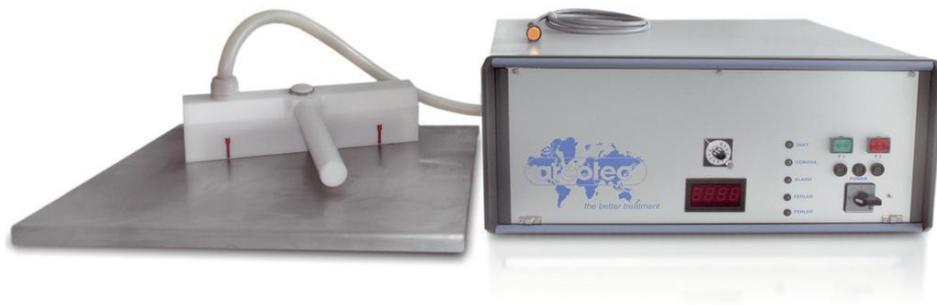
Рисунок 2.9 – Установка для обработки в униполярном коронном разряде
