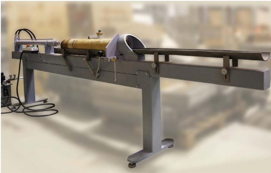
Рисунок 1.4 – Специальное устройство для извлечения керна из тубусов
