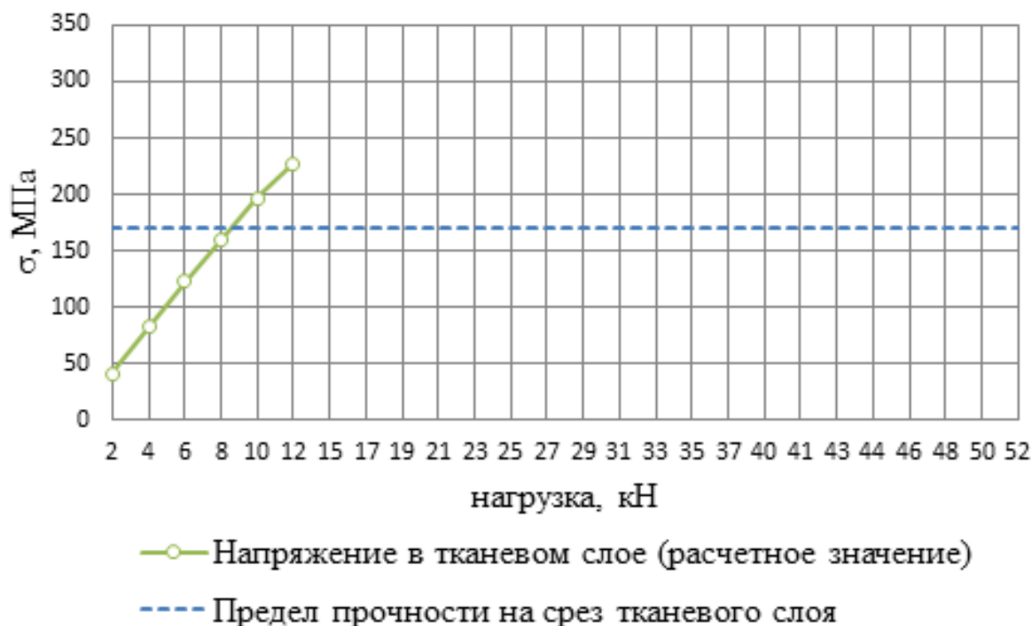
Рисунок 3.18 – Зависимость напряжения от воздействия усилия в слое 9
