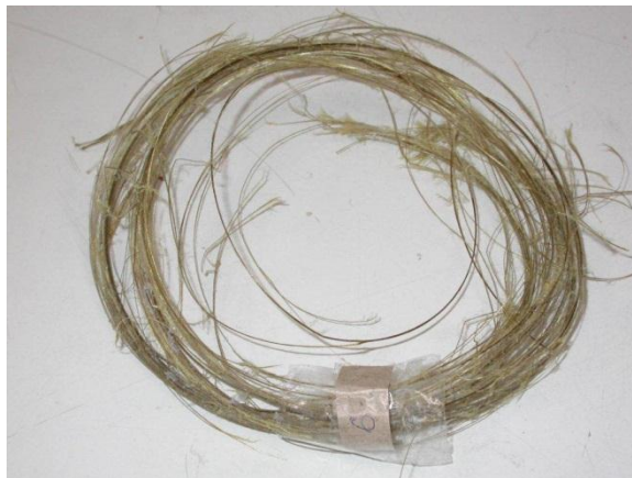
Рисунок 2.5 – Вид разрушенного кольцевого образца.
