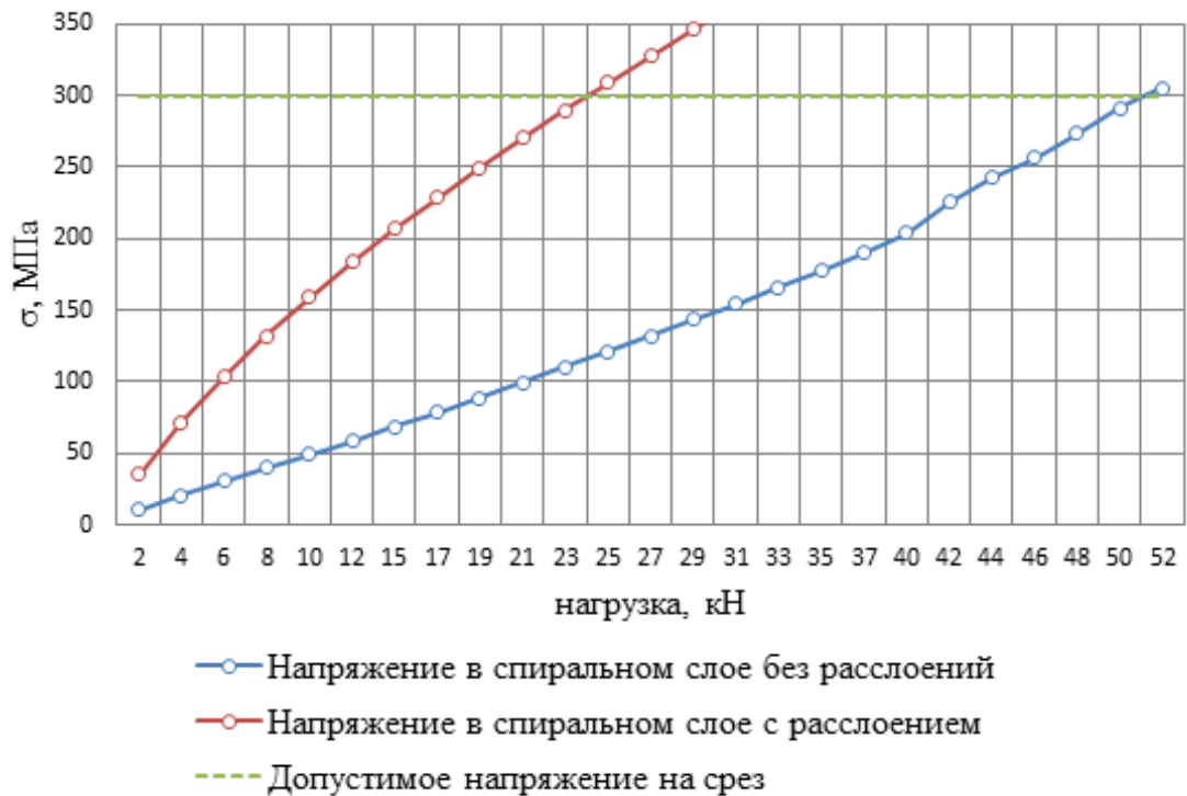
Рисунок 3.23 – Зависимость напряжений среза в спиральном слое в бездефектной конструкции и с расслоением
