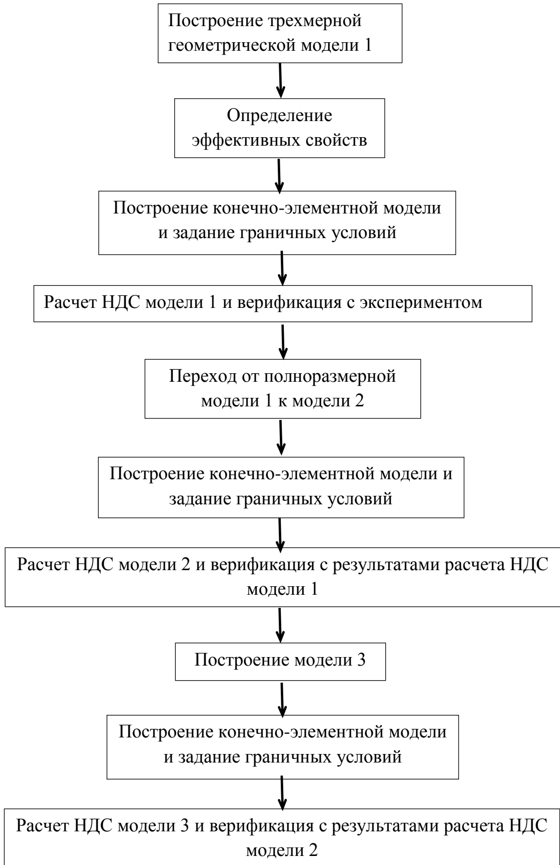
Рисунок 4.1 – Алгоритм расчета для получения напряженно-деформированного состояния крупногабаритной многослойной конструкции из композитных материалов
