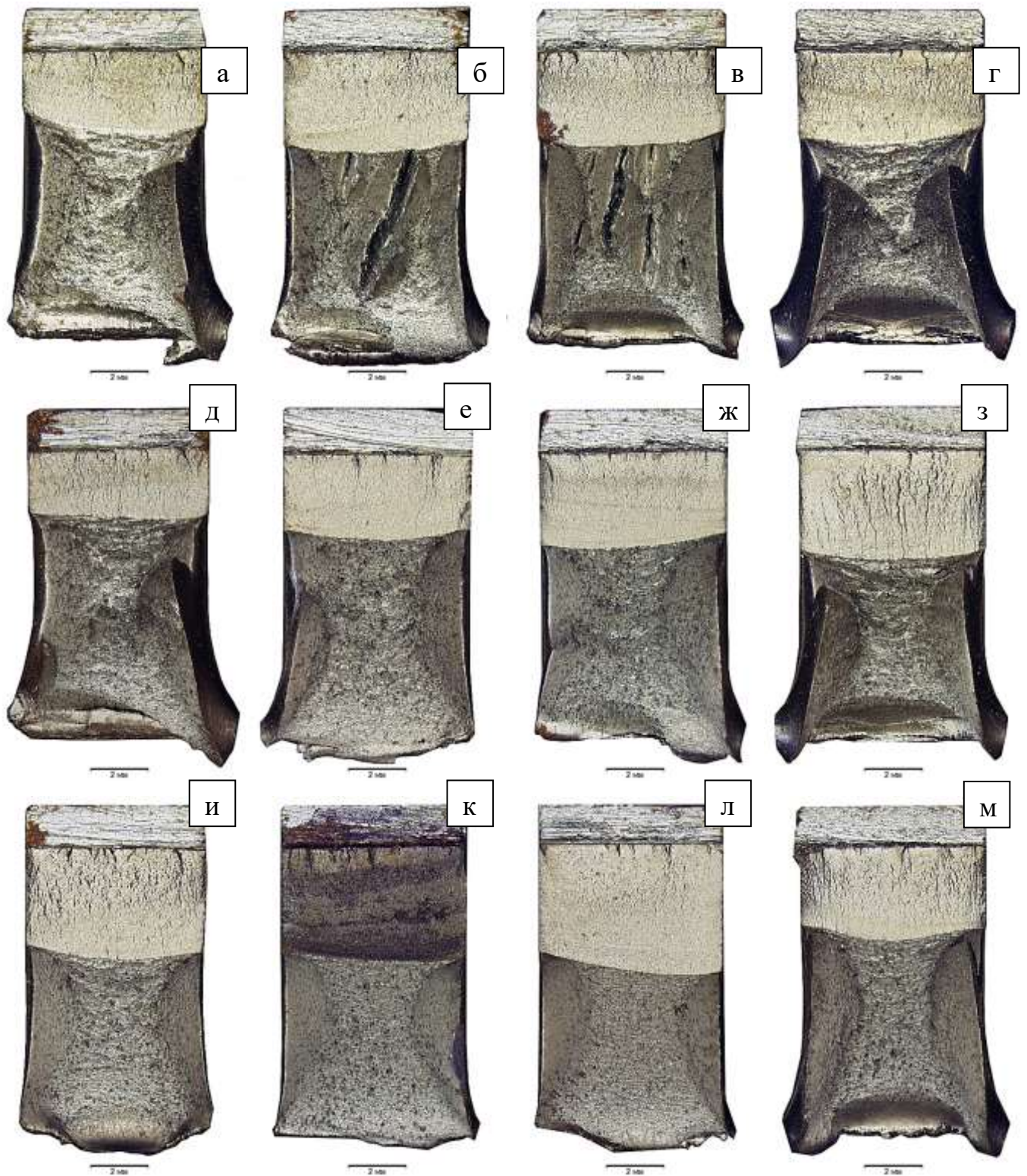
Рисунок 5.1 - Вид изломов ударных образцов из сталей 09Г2С (а-г), 25 (д-з) и 35Х (и-м), под поверхностью которых проводили исследование ЗПД: а, д, и – режим ДТО №1, б, е, к – режим ДТО №2, в, ж, л – режим ДТО №3, г, з, м – режим ДТО №4. \times 7 .
