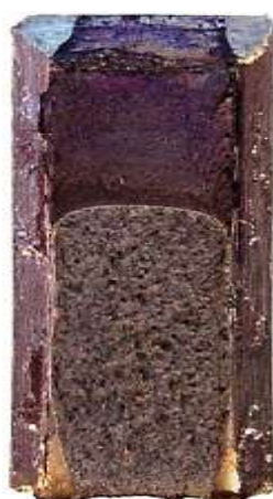
Рисунок 3.24 - Вязкие изломы образцов сталей 09Г2С (а), 25 (б), 35Х (в) после испытаний на КСТ*, обработанных по режиму ДТО №2, \times 3 .
