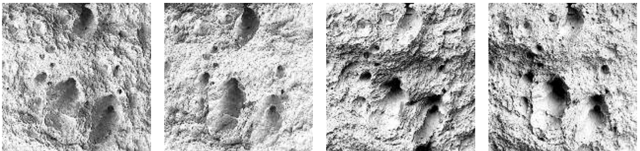
Рисунок 2.4 - Набор стереопар, полученных при помощи аппаратного модуля СЭМ FeI Phenom G2 ProX с поверхности разрушения стали 35Х, подвергнутой холодной радиальной ковке.
