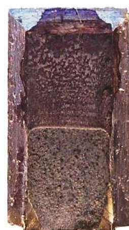
Рисунок 3.24 - Вязкие изломы образцов сталей 09Г2С (а), 25 (б), 35Х (в) после испытаний на КСТ*, обработанных по режиму ДТО №2, \times 3 .
