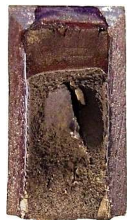
Рисунок 3.24 - Вязкие изломы образцов сталей 09Г2С (а), 25 (б), 35Х (в) после испытаний на КСТ*, обработанных по режиму ДТО №2, \times 3 .
