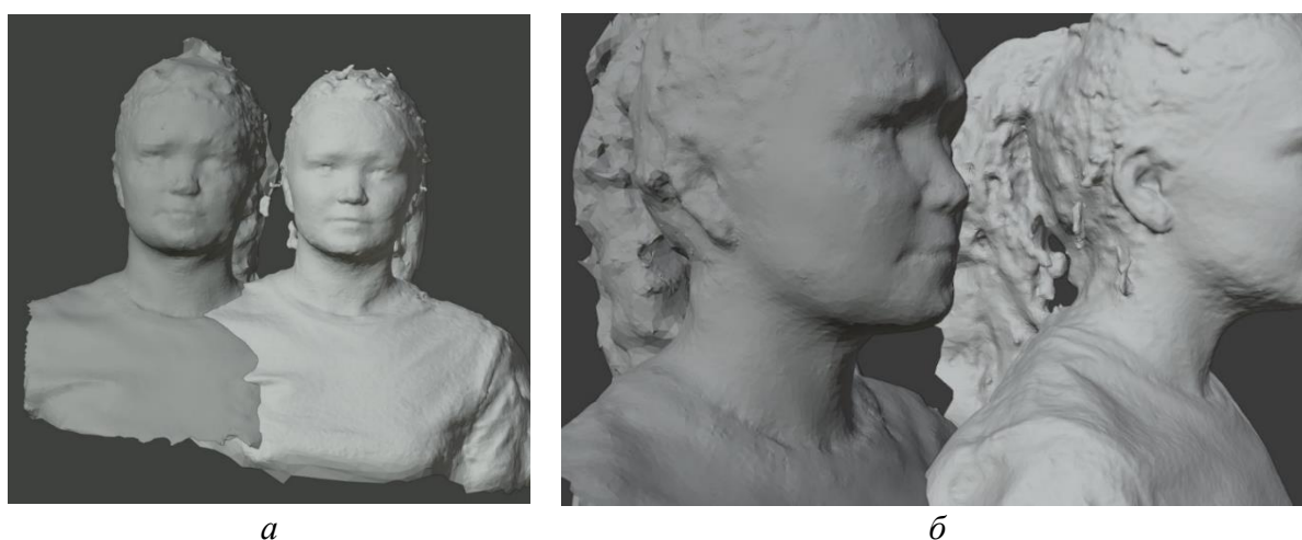
Рисунок 41 – Сравнение моделей, полученных в Meshroom (а, б слева) и Metashape (а, б справа) с разных ракурсов
