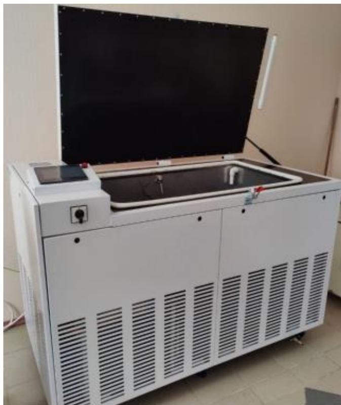
Рисунок 3.4 – Камера для определения морозостойкости
