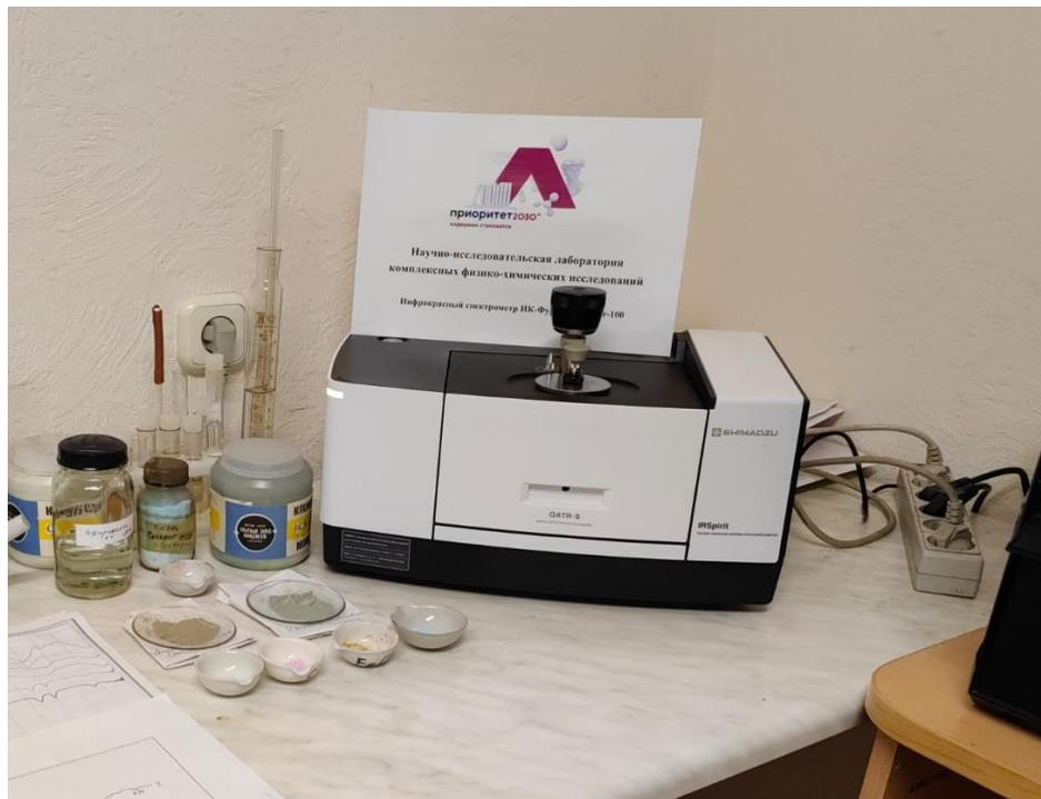
Рисунок 3.6 – ИК спектрограф фирмы «Shimadzu» IR Spirit
