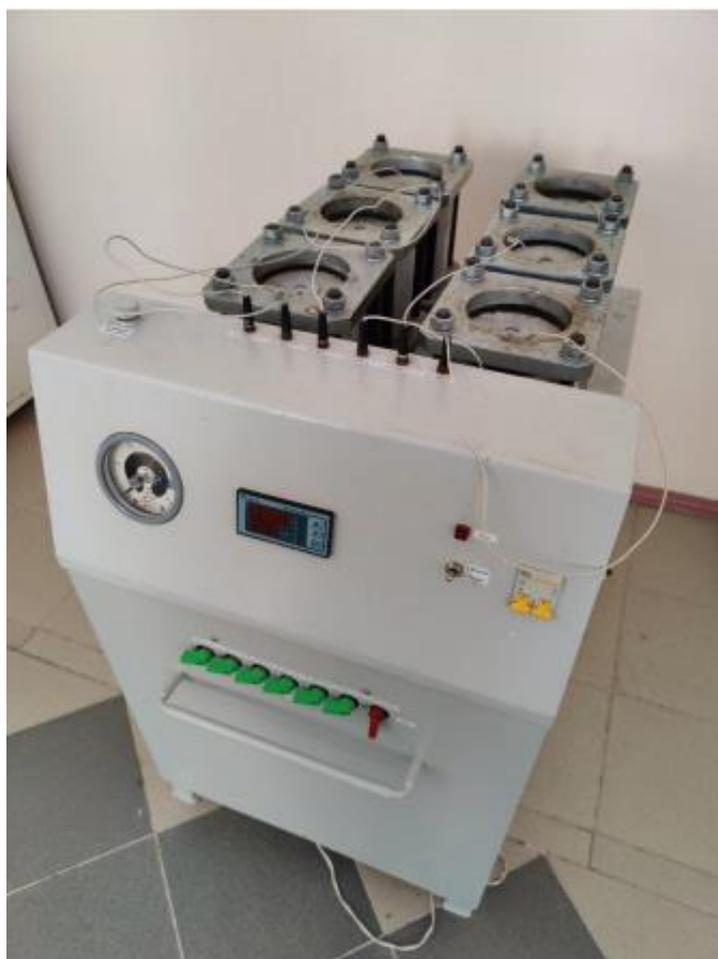
Рисунок 3.5 – Прибор УФФ-6 для определения водонепроницаемости бетона
