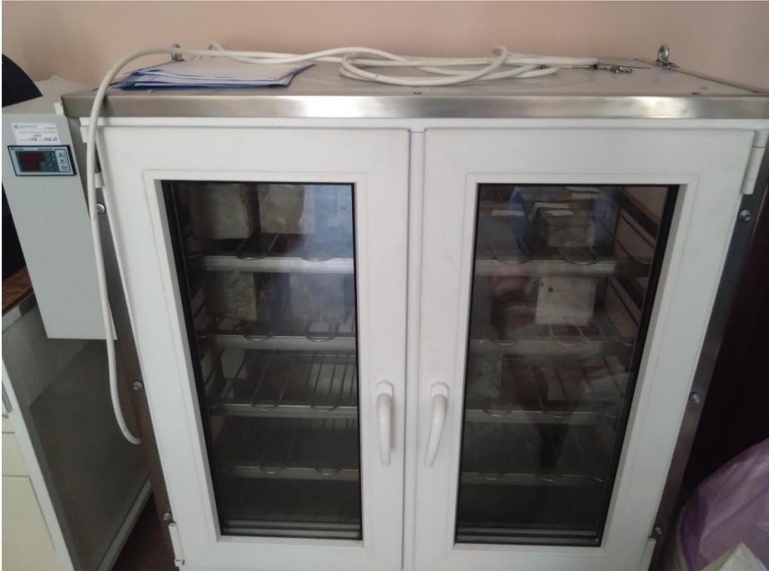
Рисунок 3.2 – Камера нормального твердения «Контрос»
